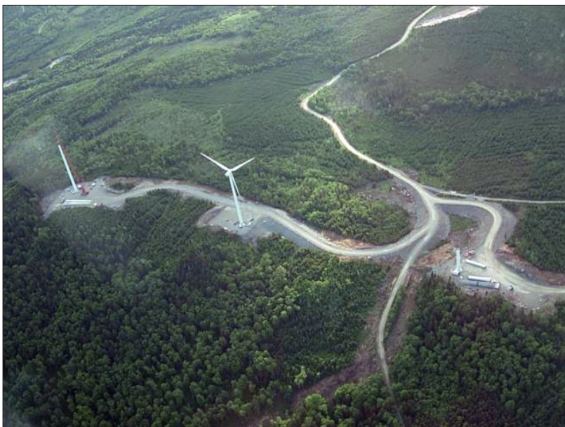
Fot. 4. Fragment farmy wiatrowej o 44 turbinach wiatrowych (3 MW) wysokości 125 m. Dodatkowo wybudowano drogi dojazdowe, sieci energetyczne i 28 mil sieci energetycznej 115 kV. Przedtem było to spokojne siedlisko leśne. Kibby Mountain, Maine, USA.
